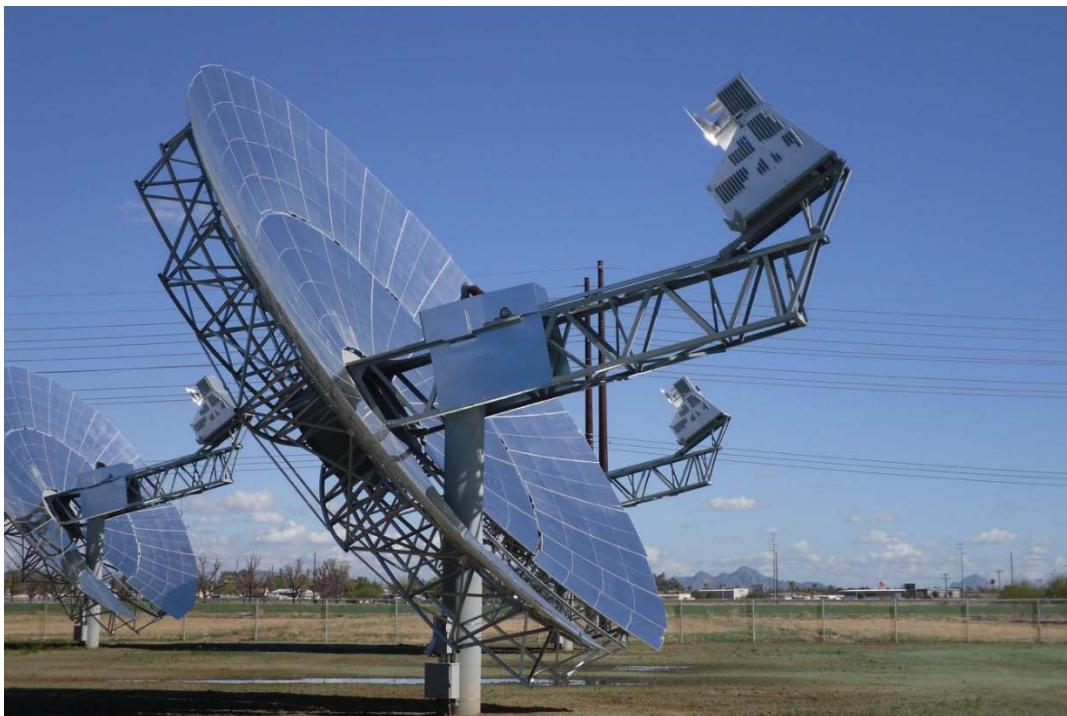
**Εικόνα 3.4. Solar Power Stirling Engine**
