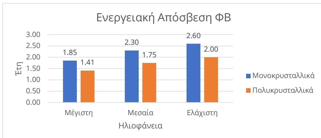
**Διάγραμμα 8.1 Χρόνος ενεργειακής απόσβεσης ΦΒ συστημάτων με μονοκρυσταλλικά και πολυκρυσταλλικά πλαίσια - κυπριακές συνθήκες ηλιοφάνειας (Μέγιστη 1800 kWh/kWp/έτος - Μέση Μέγιστη 1450 kWh/kWp/έτος - Ελάχιστη Μέγιστη 1275 kWh/kWp/έτος)**
