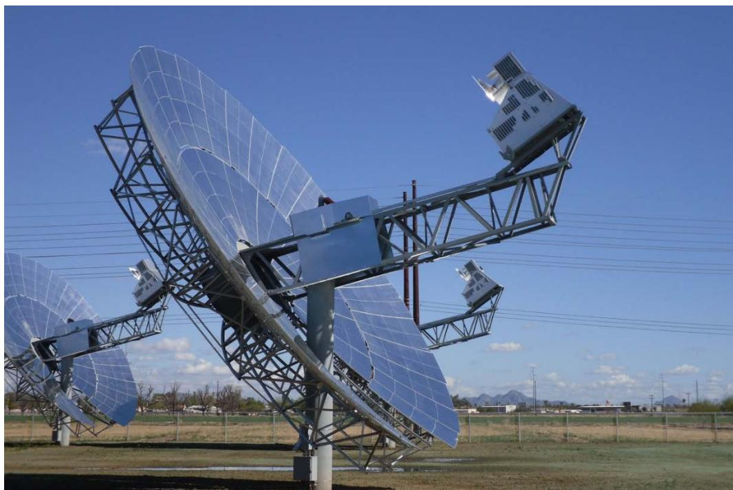
**Εικόνα 3-4. Solar Power Stirling Engine**
